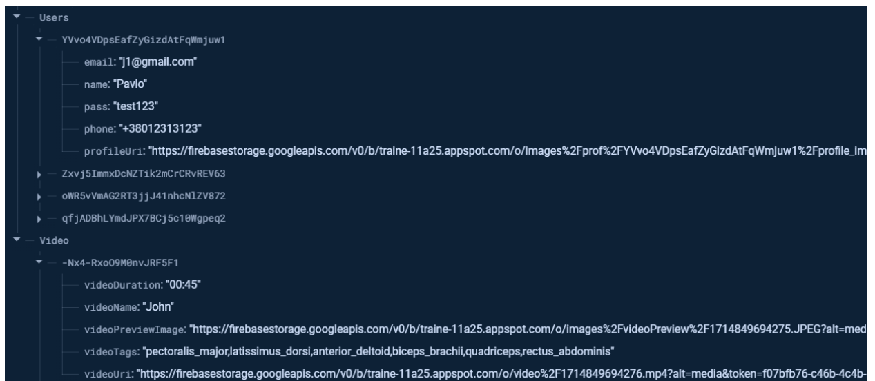
Рисунок 2.4 – Структура Firebase Realtime Database
