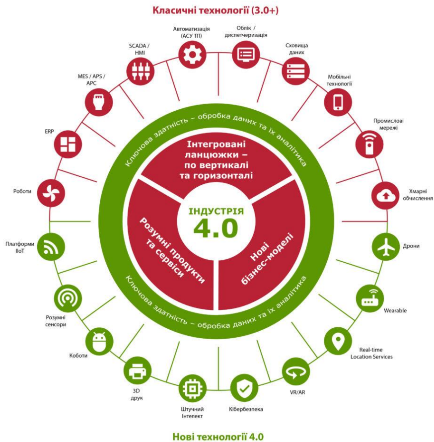
Рисунок 1.2 – Технології Industry 4.0 та Industry 3.0
