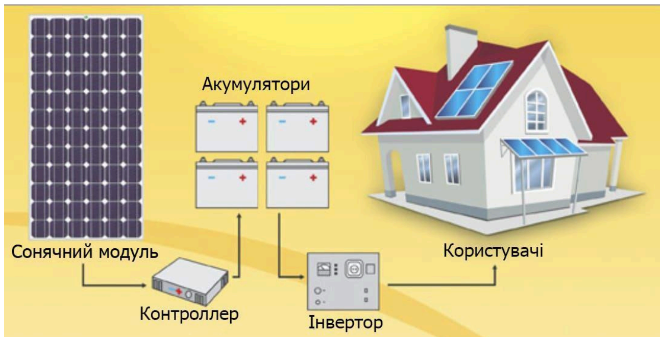
Рисунок 1.2 – Приклад роботи сонячної панелі
