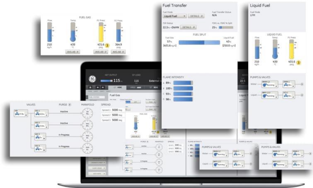
Рисунок 2.3 – використання системи SIMPLICITY SCADA для відслідковування руху та наявності палива
