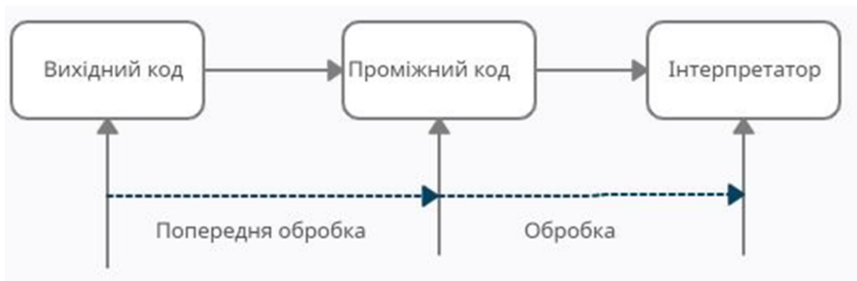
Рисунок 3.11 – Принцип роботи інтерпретатора
