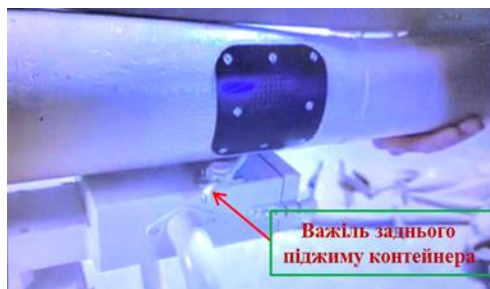
Рисунок 3.34 – Важіль заднього піджиму контейнера
