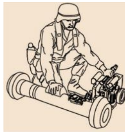
Рисунок 3.42 – Приєднання дисплею командного запуску CLU до «Javelin»
