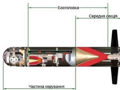
Рисунок 2.27 – Розміщення елементів бойової частини ракети
