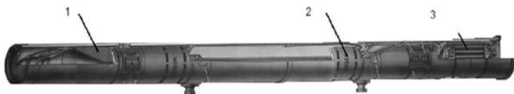
Рисунок 2.7 – ПТКР 9М114 «Кокон» у транспортно-пусковому контейнері
