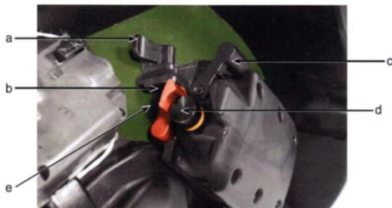
Рисунок 2.32 – Правий хват (рукоятка для стрільби): а) транспортний запобіжник, б) запобіжник, с) активатор, d) гачок, е) пластиковий виступ
