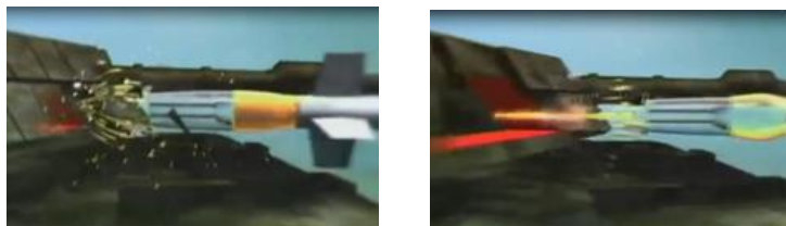
Рисунок 2.2 – Дія тандемної бойової частини ПТКР
