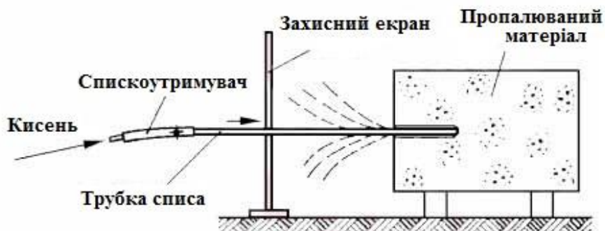
Рисунок 12.8 – Схема різання кисневим списом
