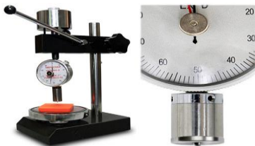
Рисунок 3 – Прилад для вимірювання твердості пластмас методом вдавлення кульки: а – загальний вигляд; б – кулька з кріпильними деталями
