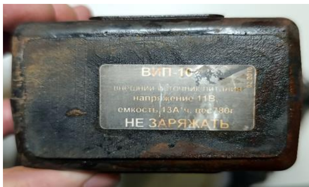
Рисунок 2. Блок живлення - нерозбірна літєва батарея ВИП-1013 (зразок 2)
