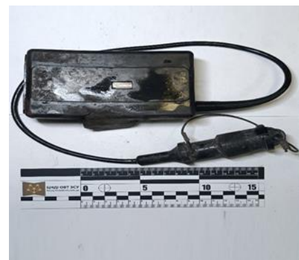
Рисунок 2. Блок живлення - нерозбірна літєва батарея ВИП-1013 (зразок 2)
