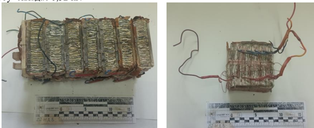
Рисунок 5 – Блок із 14 елементів джерела струму виробу (вигляд знизу) та відокремлений елемент джерела струму
