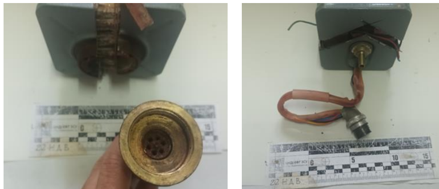
Рисунок 3 – Штуцер із клапаном і штекер для електричного підключення джерела струму
