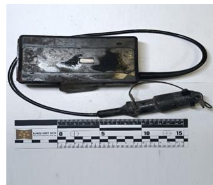
Рисунок 2. Блок живлення - нерозбірна літєва батарея ВИП-1013 (зразок 2)
