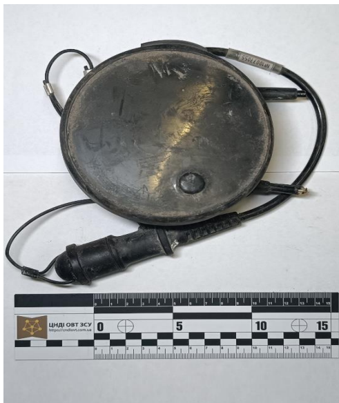
Рисунок 1. Сейсмічний радіосигналізатор РС-У (зразок 1)
