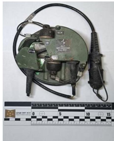
Рисунок 1. Сейсмічний радіосигналізатор РС-У (зразок 1)
