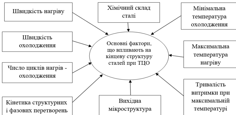
Рисунок 1 – Фактори, що впливають на кінцеву структуру сталей під час ТЦО
