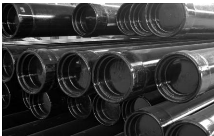
Рисунок Г.28 – Безшовні сталеві труби для крекінгу нафти, що піддаються дії високих температур
