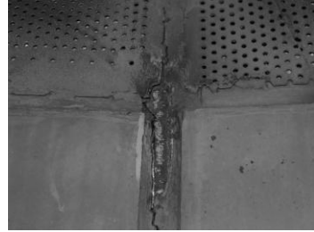
Рисунок Г.12 – Інтеркристалітна корозія в зоні, прилеглій до зварного шва деталі ралика ГПА
