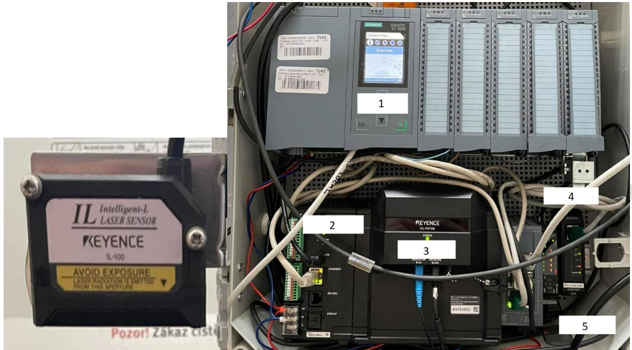
Рисунок 2.2 – Лазерний датчик тріангуляції IL100 і мобільна вимірювальна система [25]: 1 – процесор Siemens-1511C, 2 – модуль зв'язку Keyence CL-3000, 3 – підсилювач Keyence CL-P070N, 4 – модуль зв'язку Keyence DL-PN1, 5 – підсилювач Keyence IL-1000.
