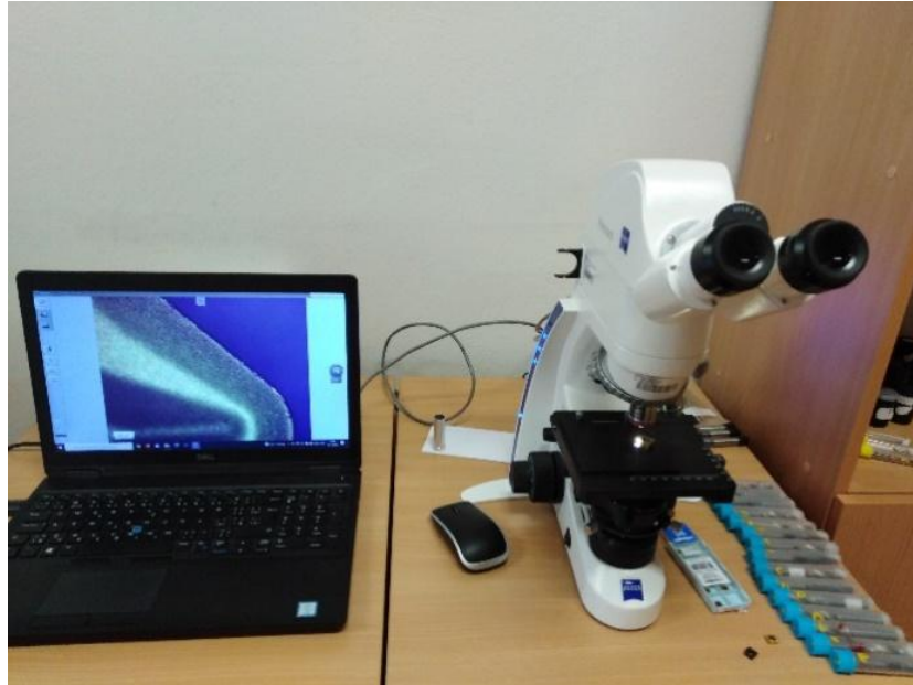
Рисунок 2.4 – Процес дослідження торцевого зносу ріжучої пластини за допомогою мікроскопа Carl Zeiss Primotech D/A ESD.
