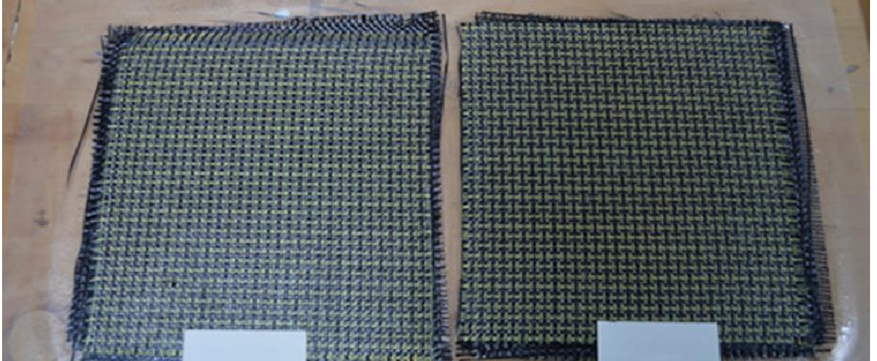
Рисунок 3.2 – Тканина, просочена епоксидною смолою Larit L-285 для зразків №2 та №4
