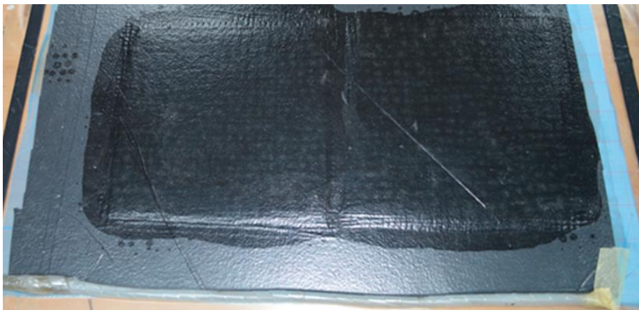
Рисунок 3.5 – Вакуумування зразків № 3 та № 4
