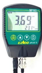
Рисунок 1.7 - РН-метр для ґрунту Ezodo MP-103S [9]
