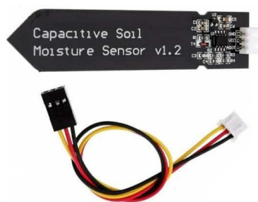
Рисунок 1.1 – Ємнісний вологомір Soil Moisture Sensor v1.2 [2]
