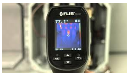
Рисунок 1.5 – Інфрачервоний термометр FLIR TG165 [7]
