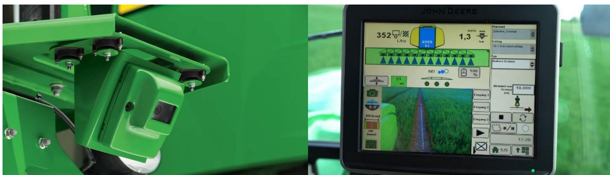
Рисунок 2.2 – Облаштування та навігація в системі John Deere AutoTrac Vision
