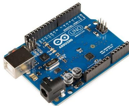
Рисунок 2.5 – Мікроконтролер Arduino Uno [17]
