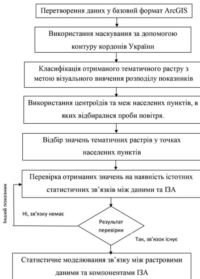
Рисунок 1.2 – Схема методики обробки даних [10]
