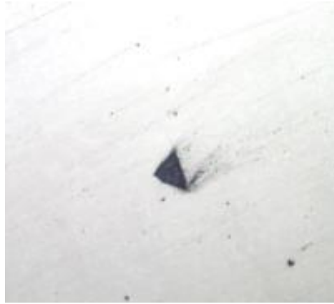
Рисунок 3.4 – Виявлені неметалеві включення, характерні для точкових оксидів, на мікрошліфі з жароміцного нікелевого сплаву, збільшення 500 разів
