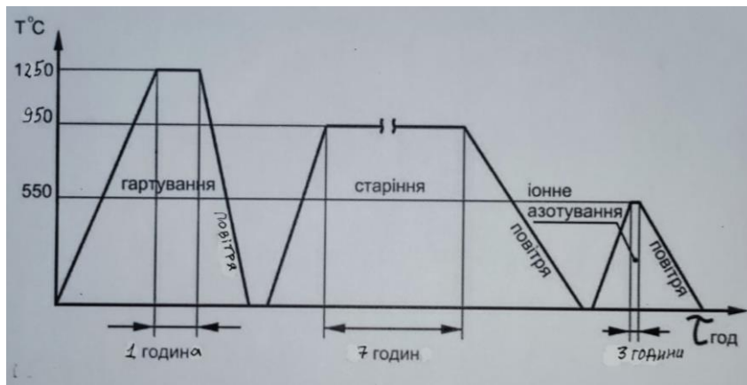
Рисунок 3.1 – Графік режиму термічної обробки зразків зі сплаву ЖС6У
