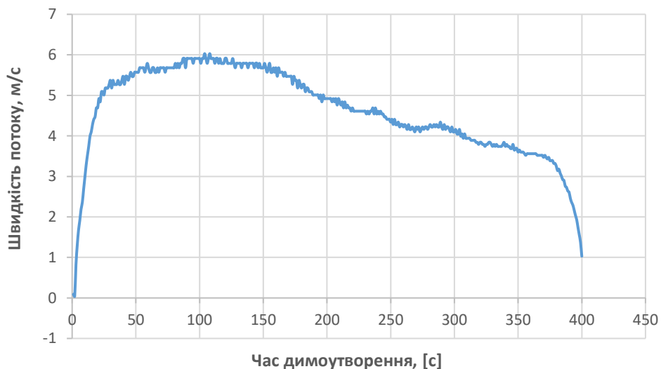
Рисунок 2.7 Відображення залежності швидкості димового потоку від часу димоутворення
