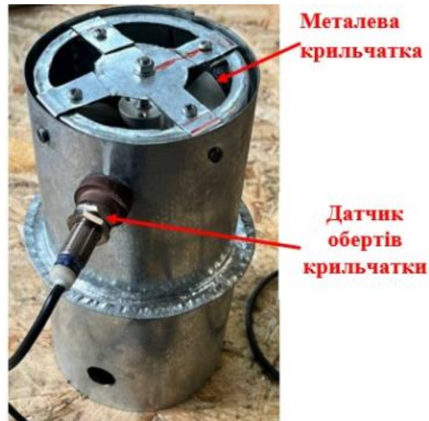
Рисунок 2.5 Розміщення металевої крильчатки у отворі труби
