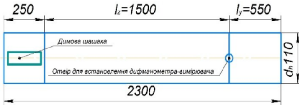
Рисунок 2.4 – Схема розмірів труби з нержавіючої сталі
