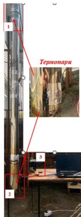
Рисунок 2.6 Стенд для дослідження характеристик димового потоку: 1- крильчатка з термопарою; 2-термопара; 3-цифровий перетворювач
