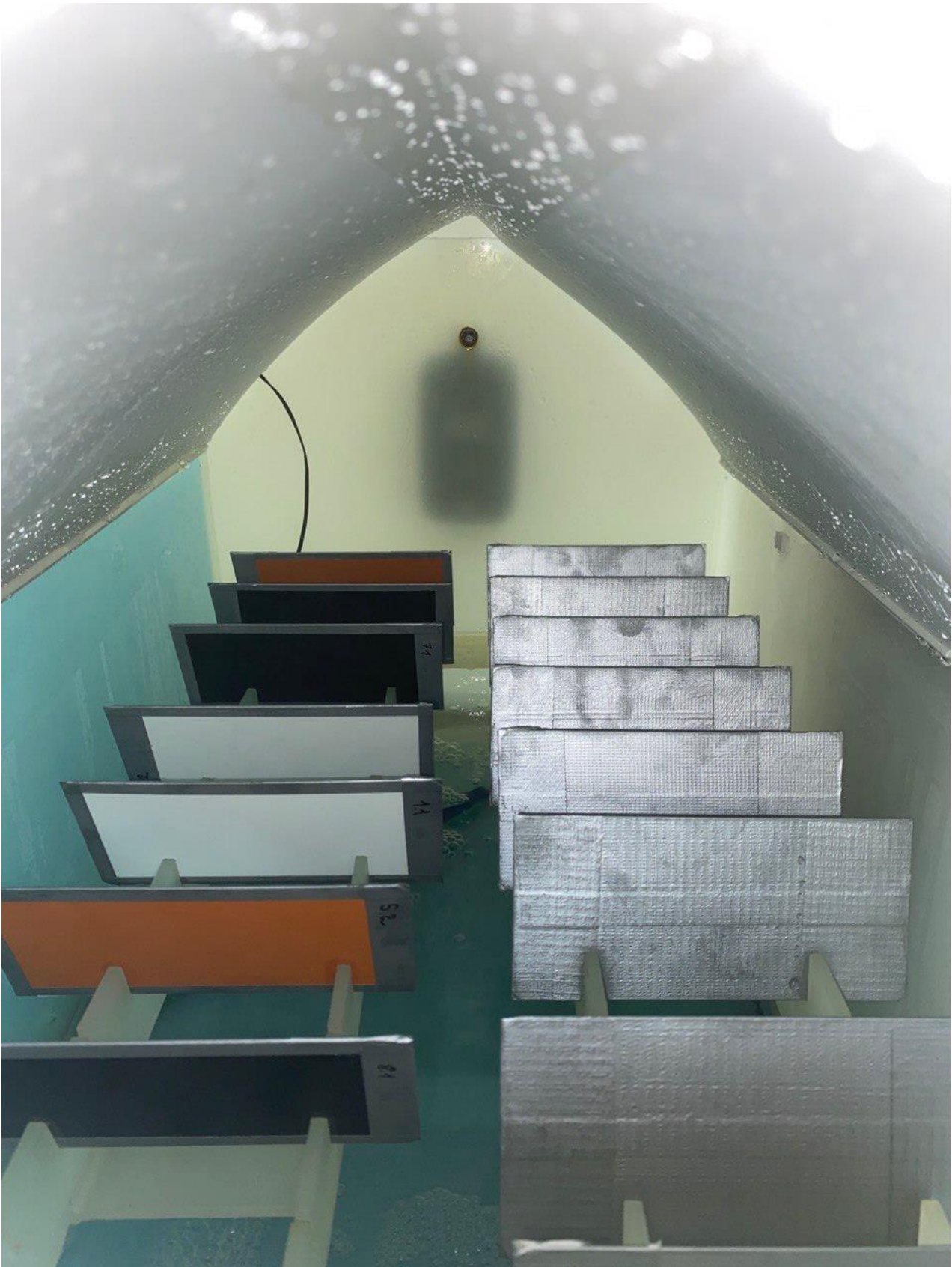
Рисунок 19 – Тестування зразків у камері конденсації вологи
