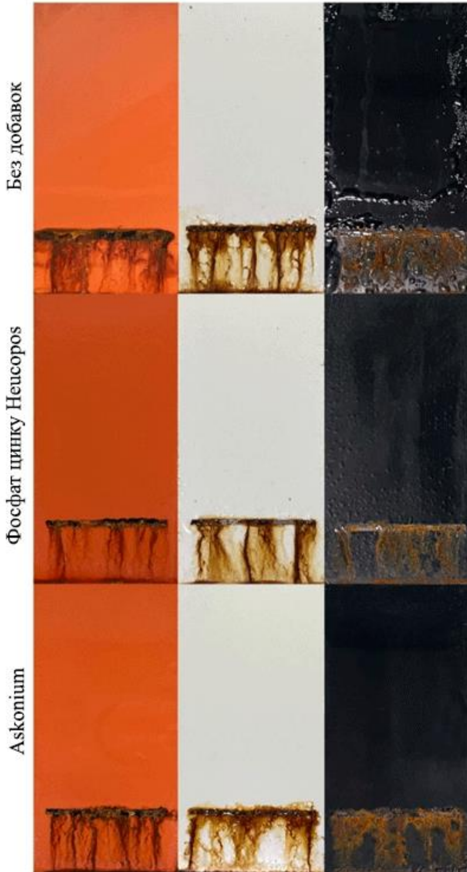
Рисунок 20 – Зразки після випробування у сольовому тумані (240 годин)
