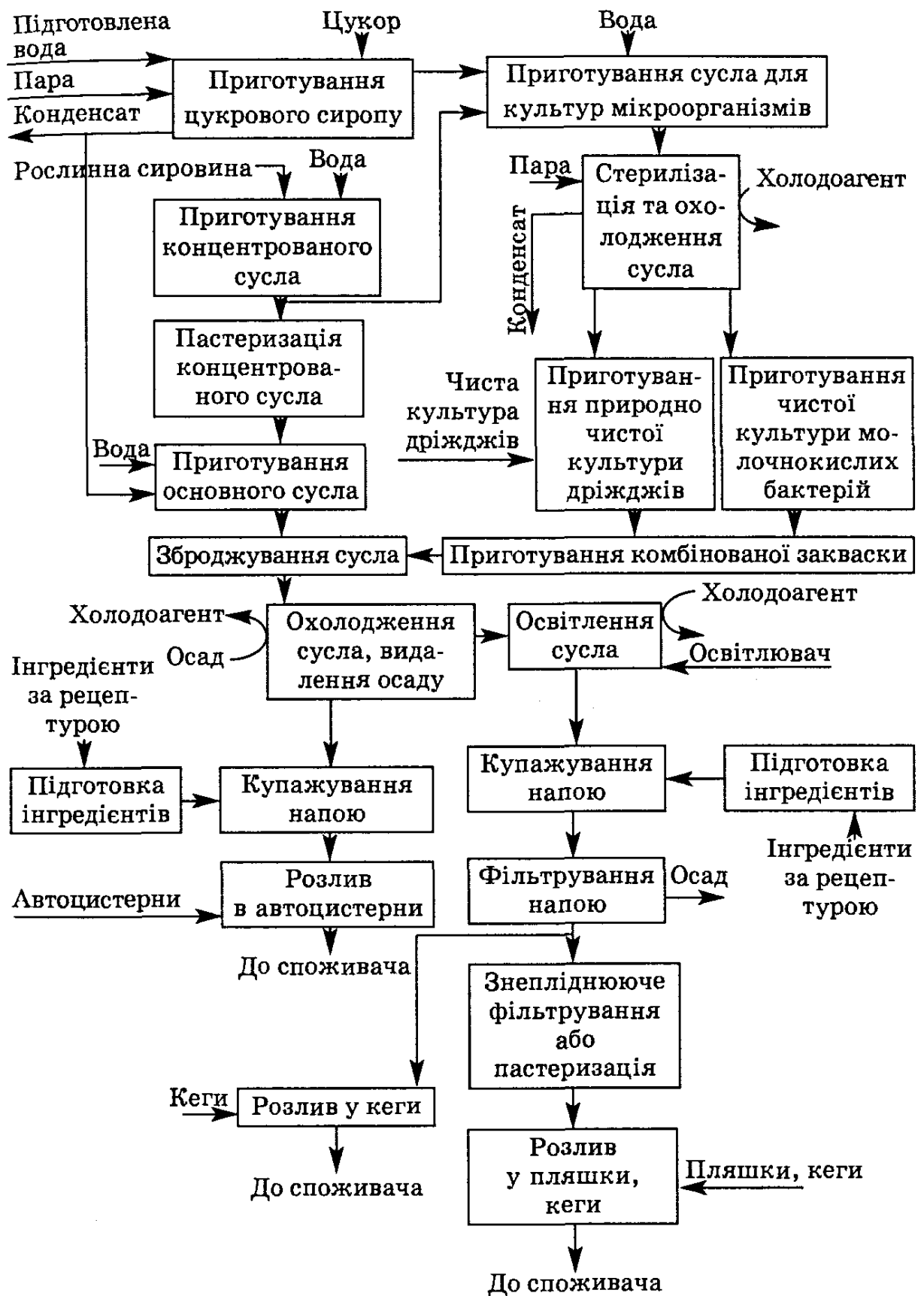
Рисунок 1- Технологічна схема виробництва напоїв бродіння
