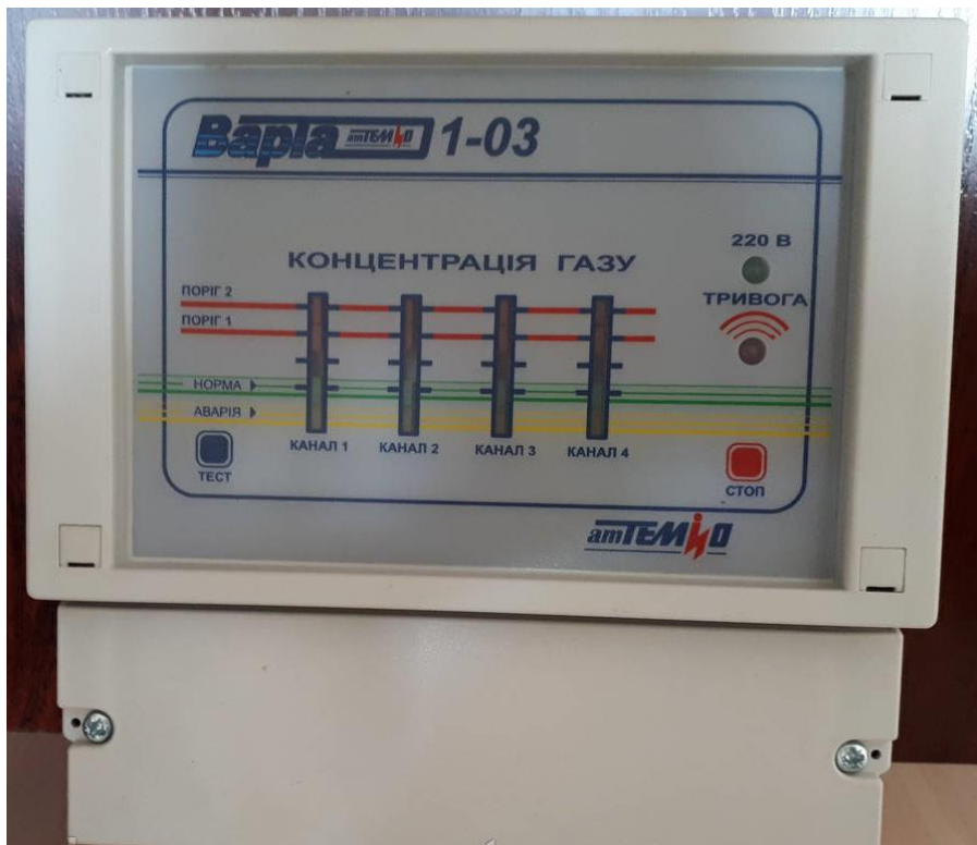
Рисунок 2.4 – Промисловий газоаналізатор Варта 1-03
