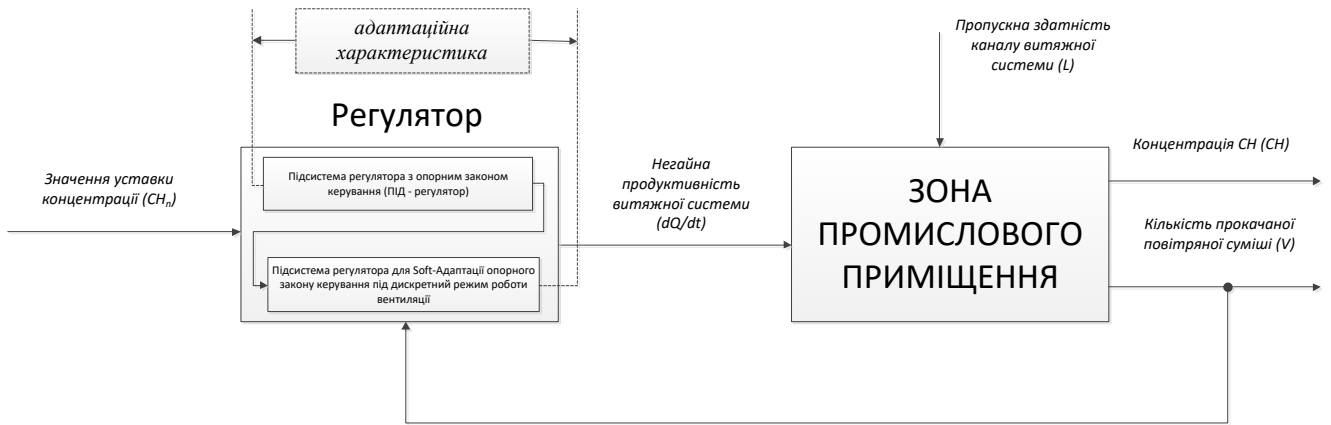
Рисунок 7.4 - Структурна схема контуру регулювання CH_4 з адаптаційною характеристикою
