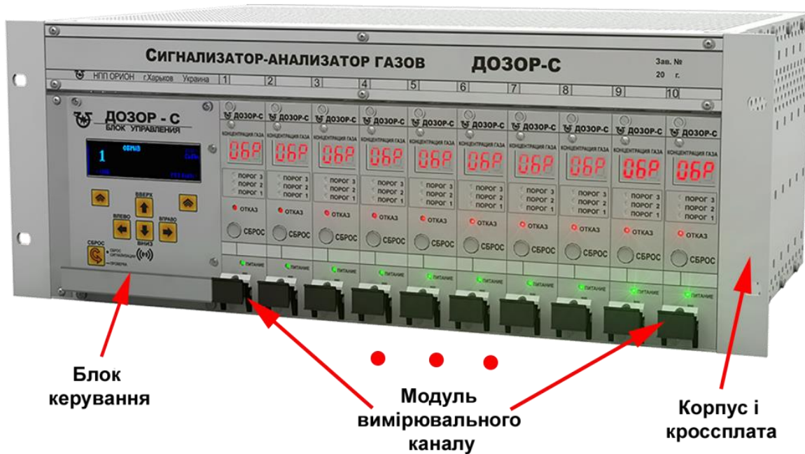
Рисунок 2.3 - Багатоканальна система загазованості Дозор-С
