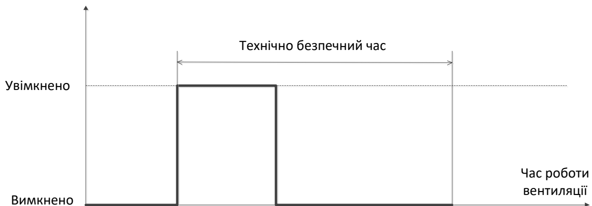
Рисунок 6.4 - Циклограма безпечної роботи вентиляції у дискретному режимі
