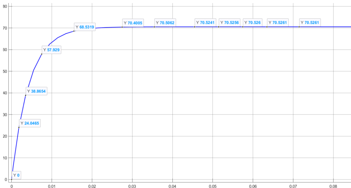
Рисунок 2.7 – Перехідна характеристика по моменту моделі ОУ отримана шляхом моделювання
