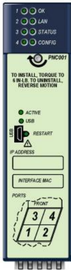
Рисунок 4.12 - Комунікаційний модуль IC695PNC001
