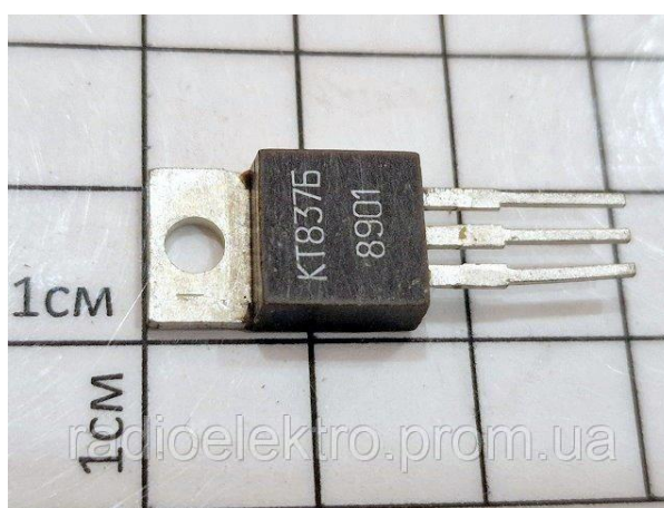
Рисунок 28 – Зовнішній вигляд транзистора КТ837
