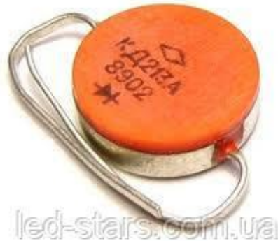
Рисунок 36- Зовнішній вигляд діода КД213А
