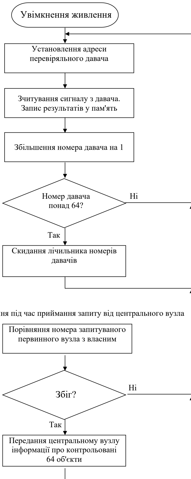
Рисунок 1.2 – Узагальнений алгоритм роботи вузла первинного контролю
