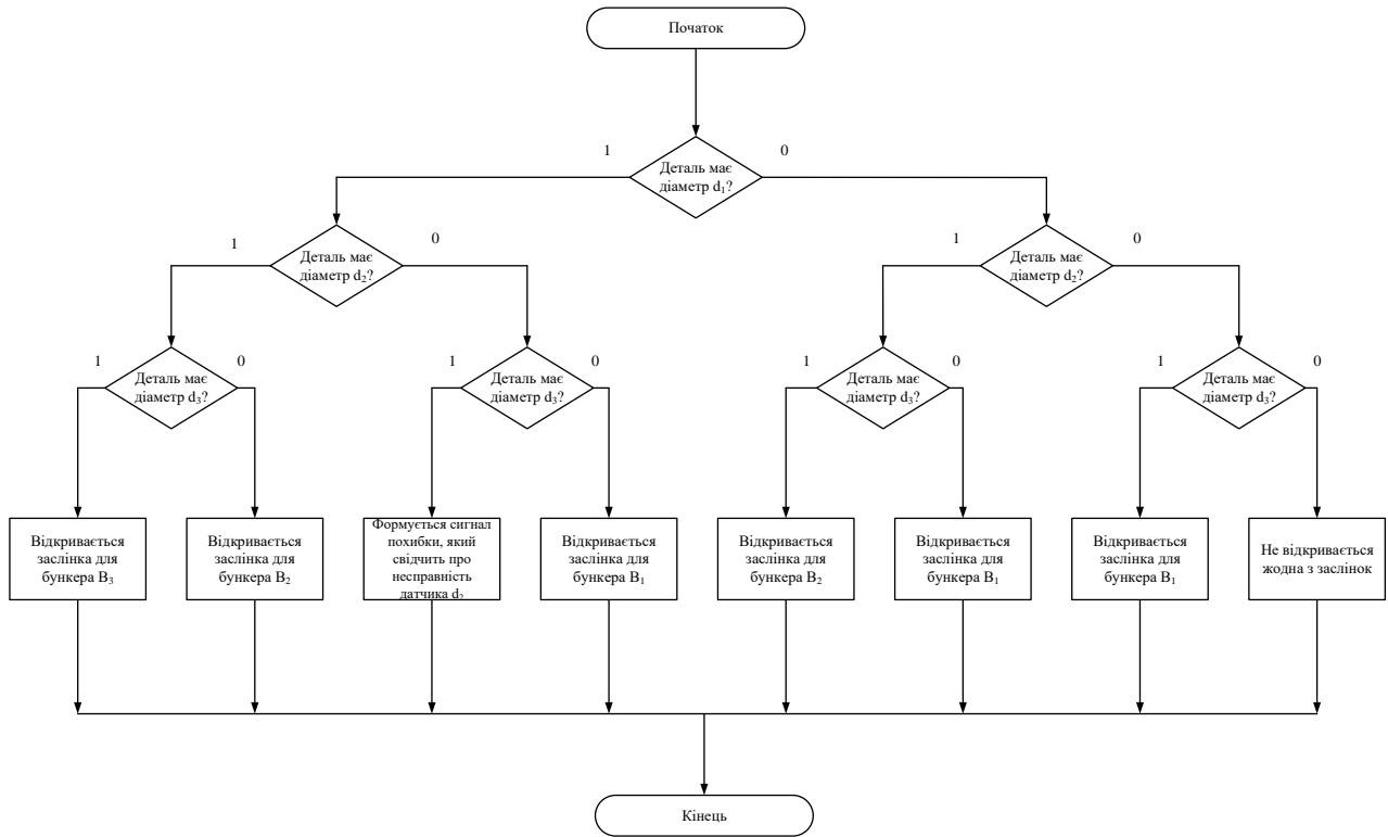
Рисунок 3.2 – Змістовна ГСА роботи керуючого автомата сортування деталей
