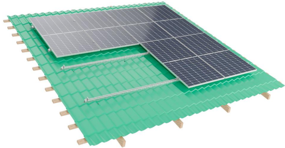
Рисунок 2.12 — Вертикальне кріплення панелей.
