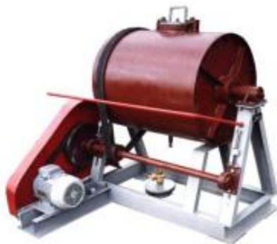
Рисунок 6.2 – Кульовий млин барабанного типу з електроприводом [26]
