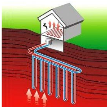
Рисунок 2.2 – Принципова схема розміщення теплового насосу [23]
