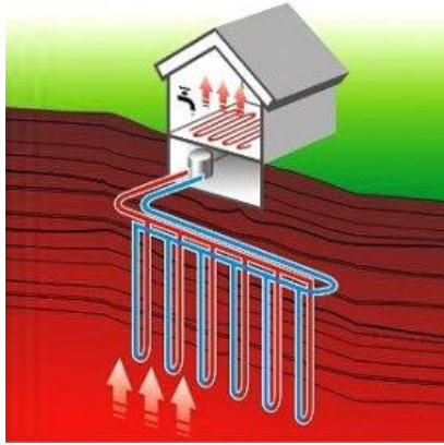
Рисунок 2.4 – Принципова схема розміщення теплового насосу [19]
