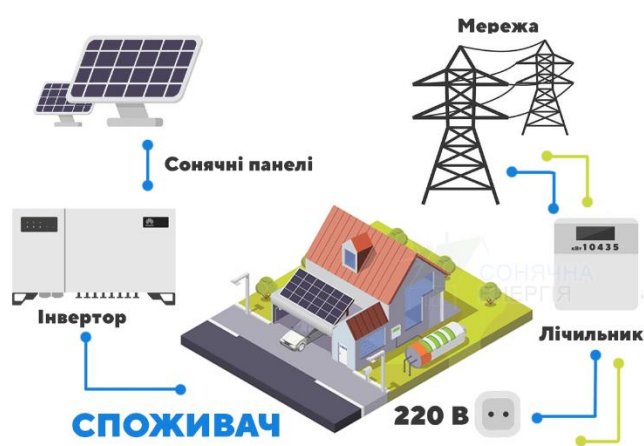
Рисунок 2.5 – Принципова схема встановлення сонячної електростанції [22]
