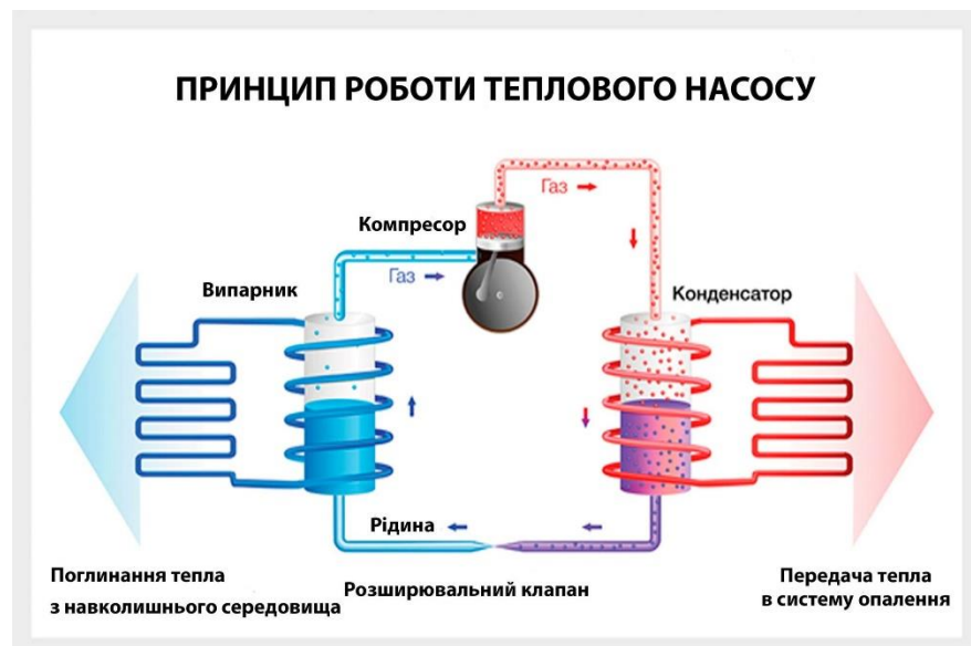
Рисунок 2.1 – Принцип роботи теплового насоса [17]
