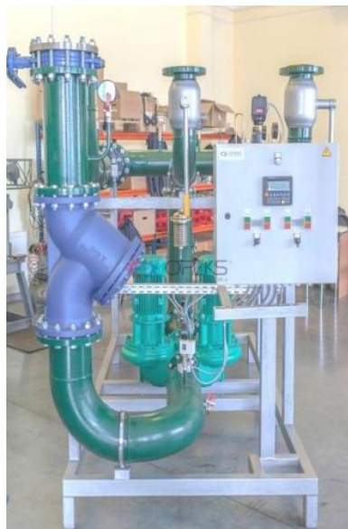
Рисунок 1.2 – Модульний блок системи опалення [3]
