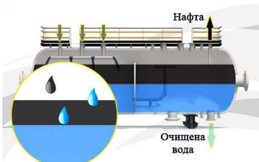
Рис.3 – Схема резервуару для відстоювання води
