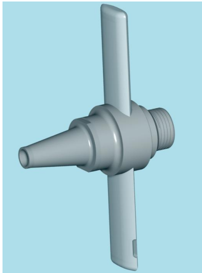
Рисунок 3.3 – Робоче колесо СРРМ: (а) – твердотільна модель, б) - профіль трубок
