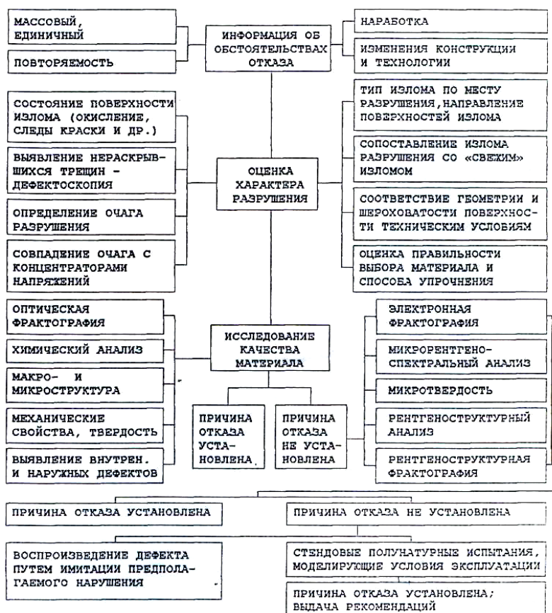
Рисунок 10.1 – Алгоритм диагностики отказов деталей машин
