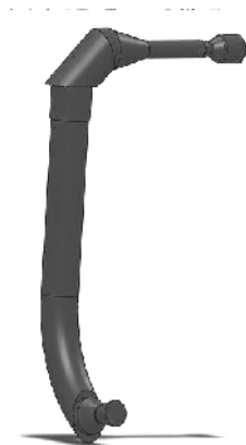
Рисунок 3– Эскиз исследуемой проточной части СРТ (слева – подвод, справа – тяговое сопло)
