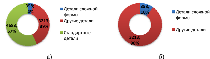
Рис. 2. Процентное соотношение деталей сложной формы в автомобиле ГАЗ 3102: а – с учетом стандартных деталей; б – без учета стандартных деталей
