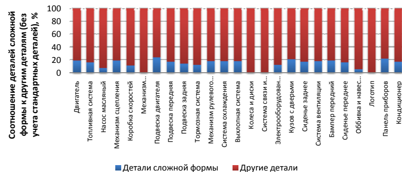
Рис. 8. Процентное соотношение деталей сложной формы в узлах автомобиля LIFAN LF-7162 Solano
