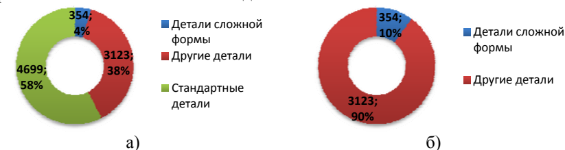
Рис. 3. Процентное соотношение деталей сложной формы в автомобиле ВАЗ 2121 (LADA 4x4): а – с учетом стандартных деталей; б – без учета стандартных деталей
