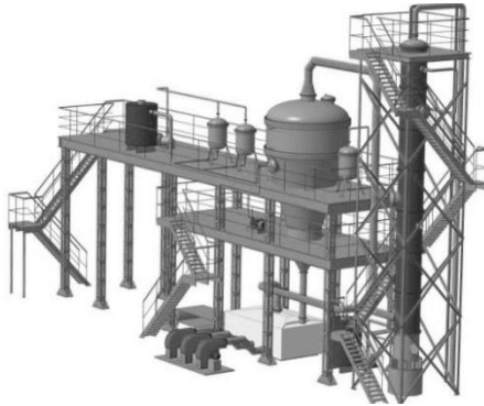
Рис. 9.9. Компонівка установки отримання гранул пористої аміачної селітри
