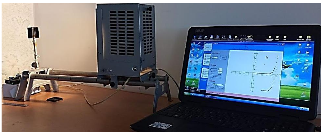
Рис.2. Зовнішній вигляд обладнання для вимірювання ВАХ ФЕП
