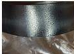
Рисунок 1 – Зразки сталі 14X17H2 після випробувань на МКК, метод АМУ
