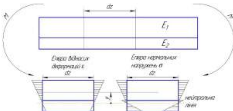
Рисунок 1 – Розрахункова схема чистого прямого згинання двошарової суттєво неоднорідної балки
