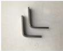
Рисунок 1 – Зразки сталі 14X17H2 після випробувань на МКК, метод АМУ
