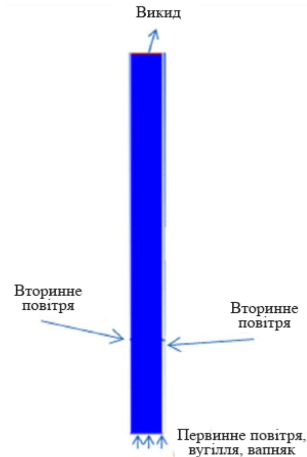
Рисунок 3.6 – Граничні умови камери згоряння з циркулюючим киплячим шаром
