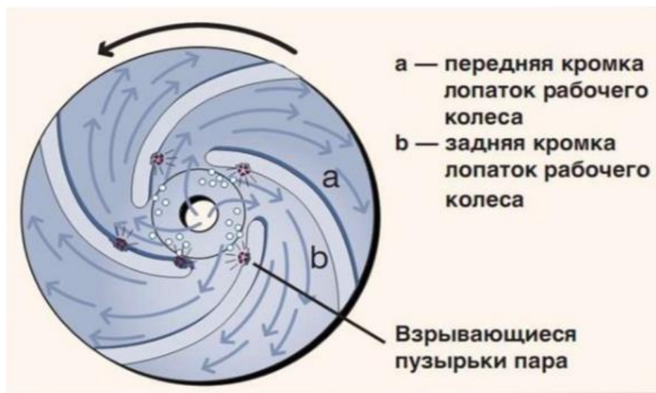
Рисунок 18 – схема виникнення кавітації
