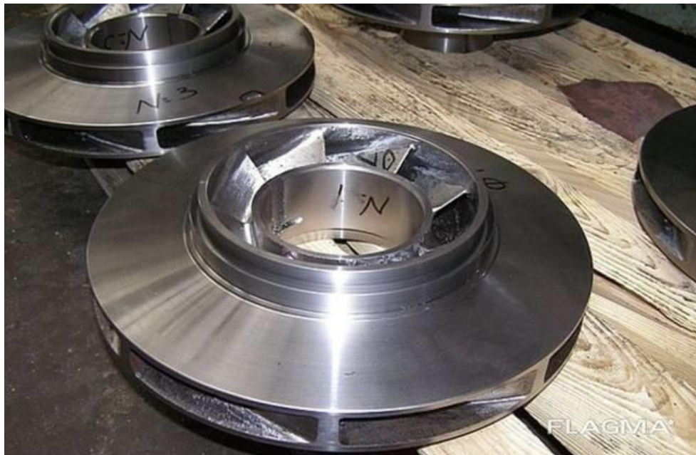
Рисунок 9 - Робоче колесо насоса типу ЦНС
