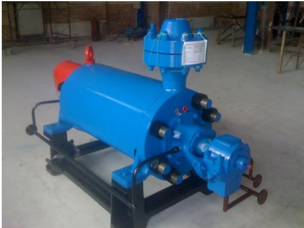
Рисунок 5 – Насос ЦНС вигляд зовні
