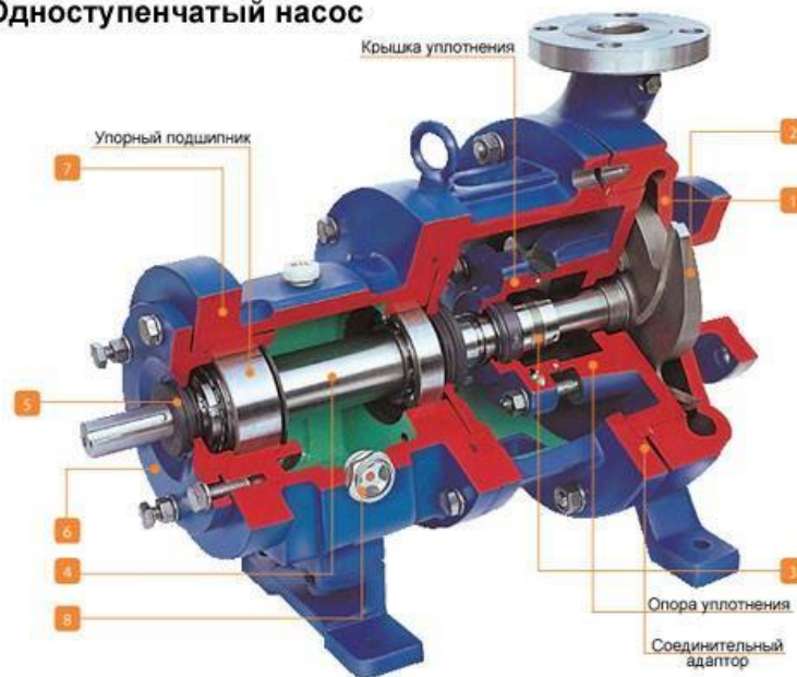
Рисунок 3 – Схема відцентрового насоса
