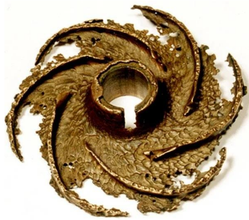
Рисунок 19 – результат перекачування абразивів
