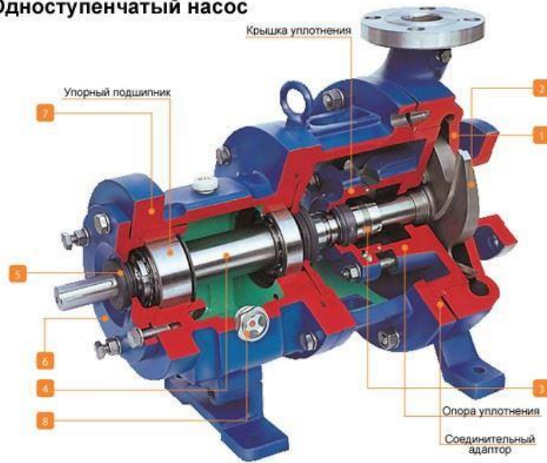
Рисунок 1 – Схема відцентрового насоса
