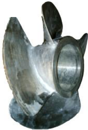
Рисунок 4 – Рабочее колесо насоса ОХВ
