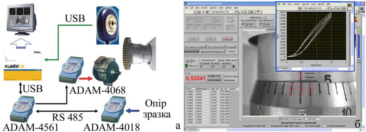
Рис. 2.15. Структурна схема автоматизованої системи дослідження тензоефекту (а) та інтерфейс програмного забезпечення (б)
