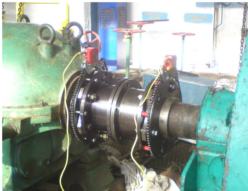
Рисунок 4 - Муфта МСК-1700 соединения "электродвигатель-мультипликатор" компрессора 4VRM200/490.
