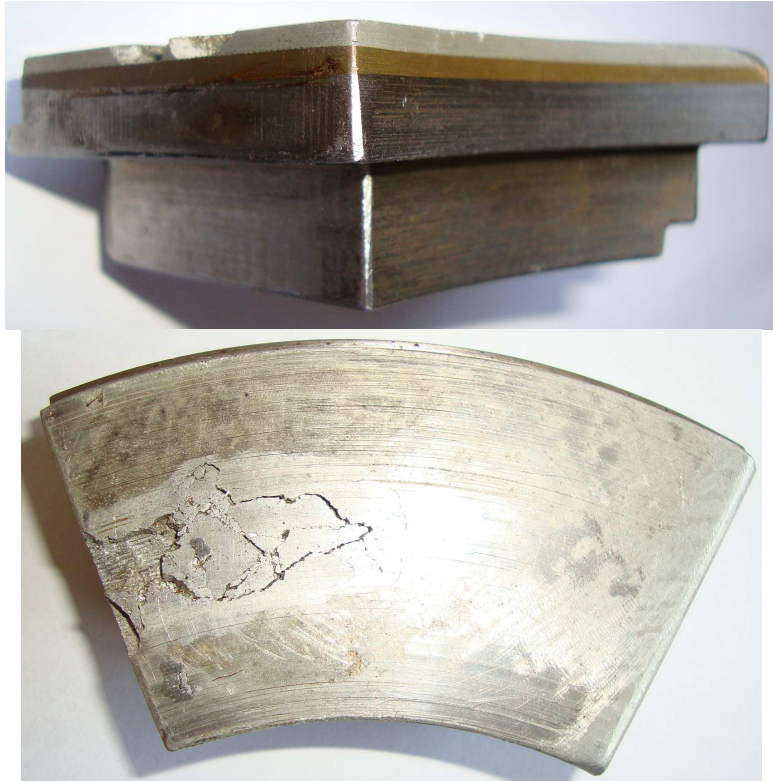
Рисунок 11 - Колодка с переходным бронзовым слоем и рифленой поверхностью
