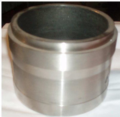
Рисунок 9 - Статорная втулка насоса, упрочненная методом ЭЦ
