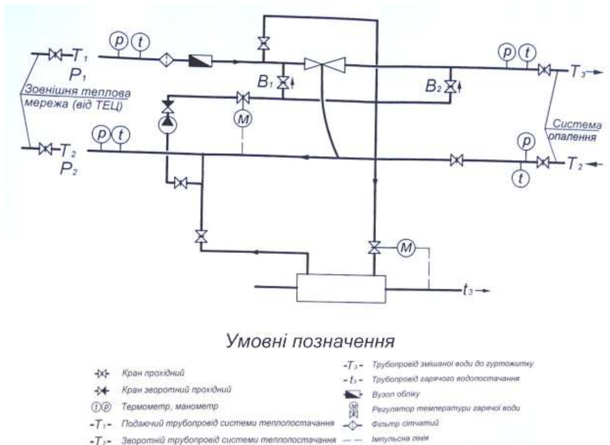
Рисунок 4.3 – Схема тепловпункту з насосом підмішування
