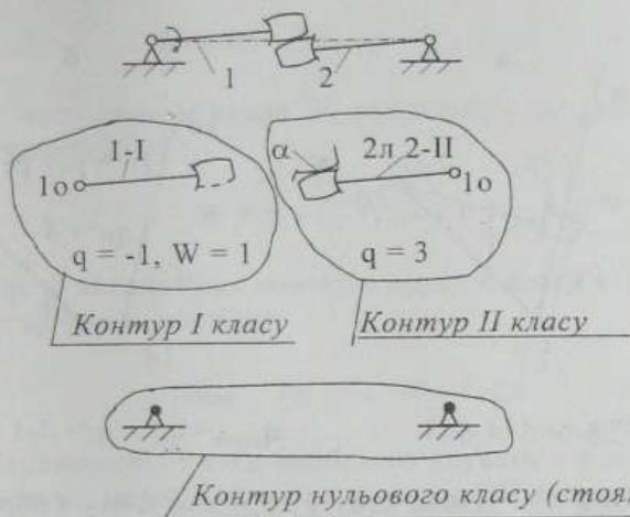
Рисунок 23 - Структурний аналіз триланкового плоского зубчастого механізму
