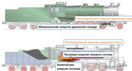
Рисунок – Процессы преобразования энергии в паровозе
